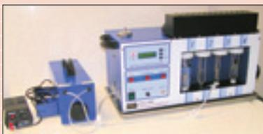
Pompe de nettoyage du circuit de piégeage PRC14
