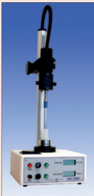
Electrodéposeur monoposte EDP7000
