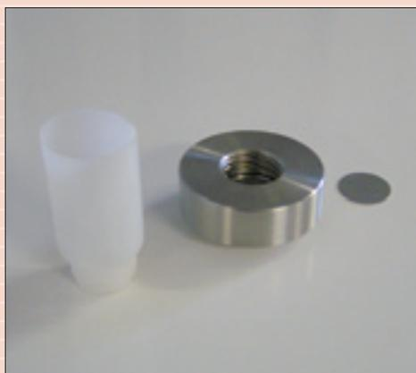
Flacon (20ml), porte-flacon et disque d'électrodéposition
